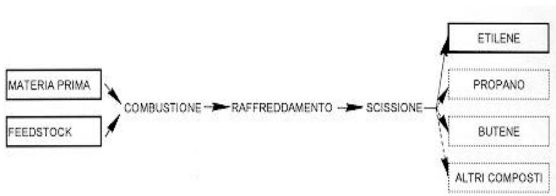
Tavola 27: Schema di flusso del processo di cracking per ottenere l'etilene. (Fonte: APME, 1994)
