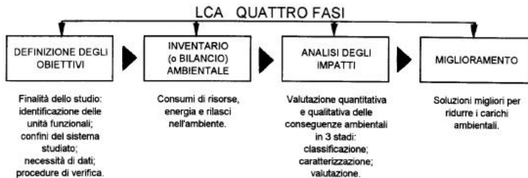
Tavola 3: Schema delle quattro fasi di cui è composta l'analisi del ciclo di vita. (Fonte: Nostra elaborazione)
