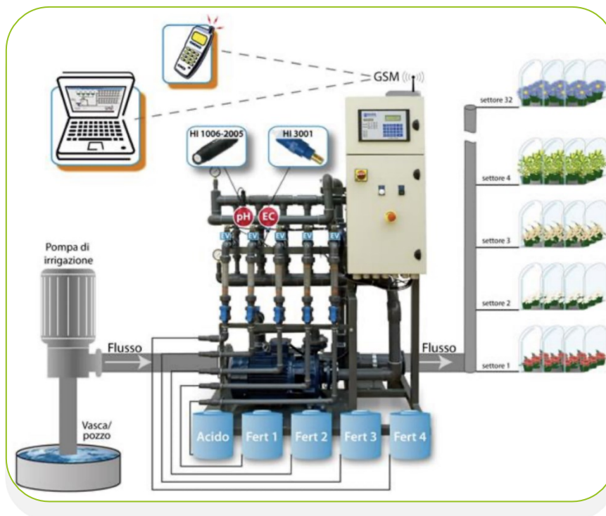
Figura 3.13 - Schema di un impianto di fertirrigazione (Fonte: Hanna Instruments)
