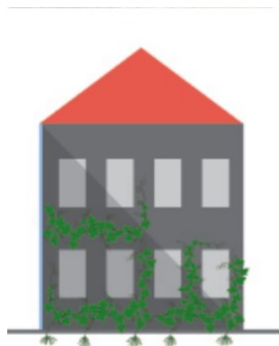
Figura 3.5 - Facciata verde diretta con piante in piena terra (Fonte: DannenbergstraÙe in Hannover – Green Hannover (green-hannover.de) )
