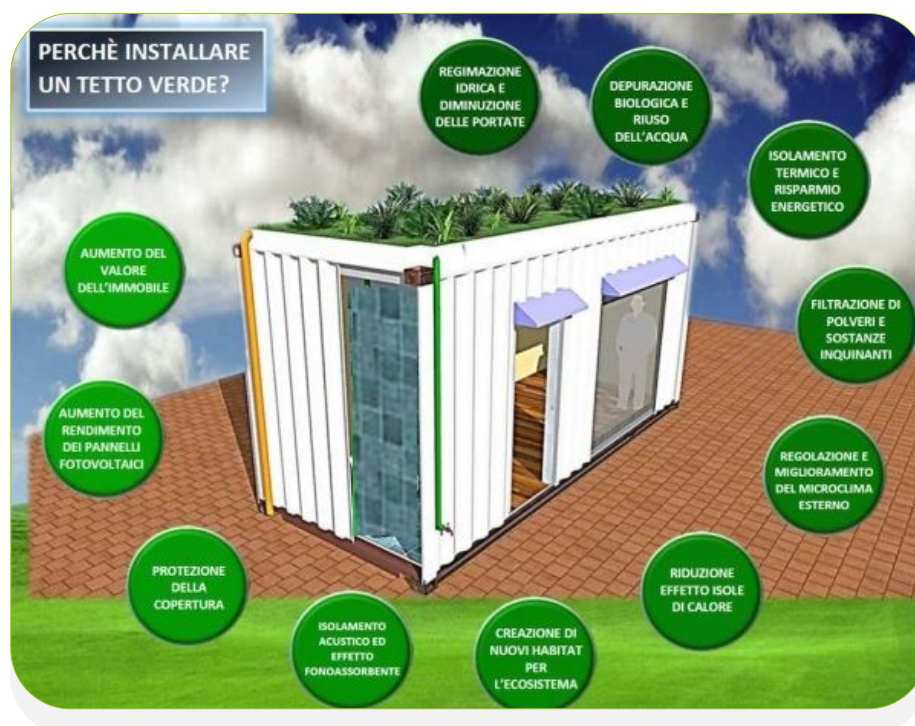
Figura 2.1 - Alcuni vantaggi dell'installazione di un tetto verde
