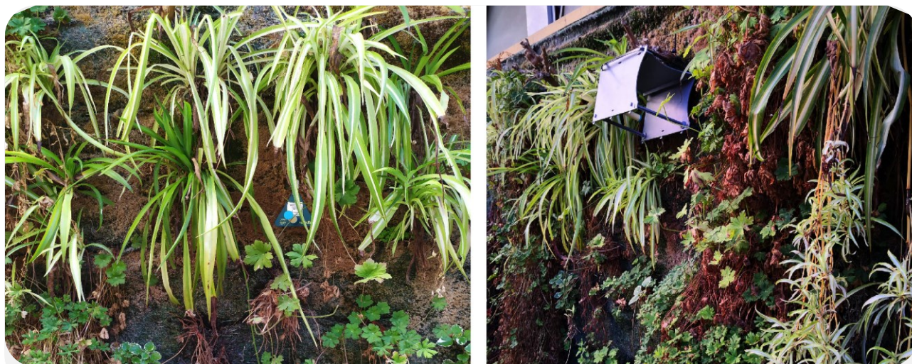
Figura 5.23 - Campionamento BTEX sulla parete verde del Liceo Keplero di Roma
